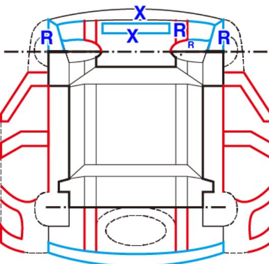
代號說明: R:有板金修復跡 X:有更換歷 B:有超過拳頭大之凹陷 S:生銹
