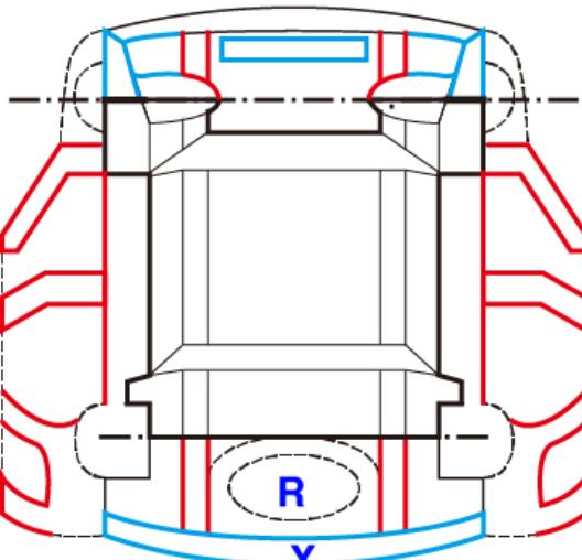
代號說明: R:有板金修復跡 X:有更換歷 B:有超過拳頭大之凹陷 S:生銹
